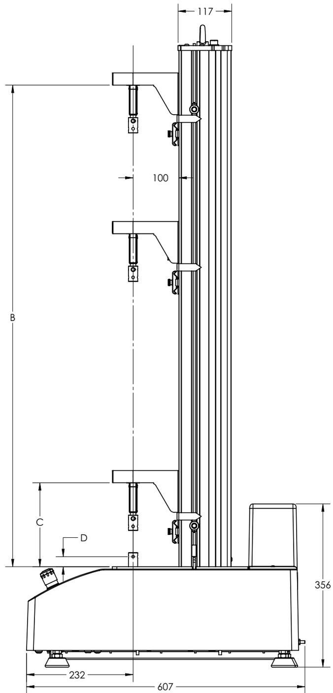
图 4.34SC-5 机架尺寸 - 侧面视图
